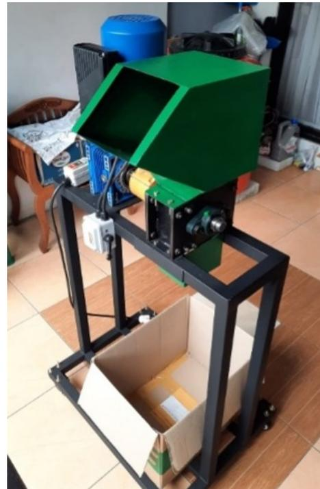
Fig. 6. Mesin Pencacah plastik setelah proses manufaktur
