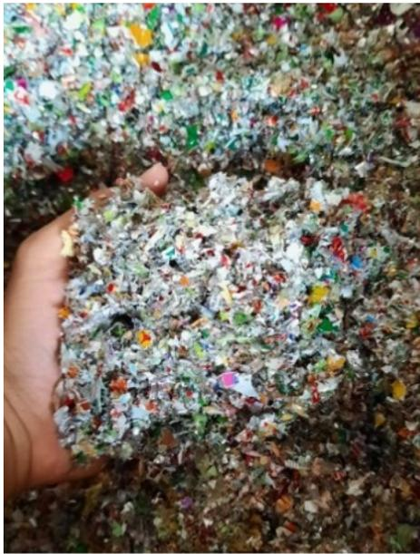
Fig. 7. Plastik setelah proses pencacahan
