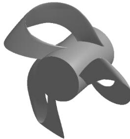
Gambar 2 Bentuk tiga dimensi toroidal propeller
