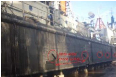
Gambar 6 Contoh aktual jarak antar anoda pada kapal
